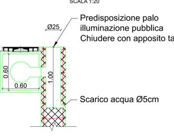
SEZIONE A MURO DI SOSTEGNO ALTEZZA 1,60m
