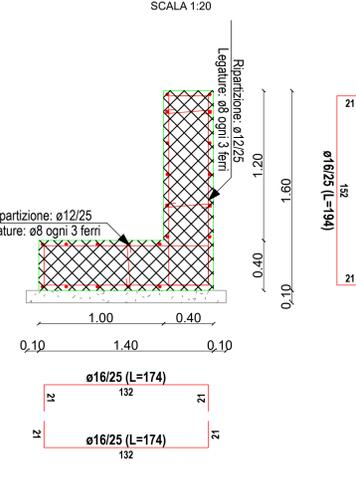
SEZIONE B MURO DI SOSTEGNO ALTEZZA 2,20m
